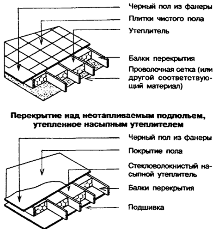
Рисунок 9.3 - Утепление перекрытий над неотапливаемыми помещениями
