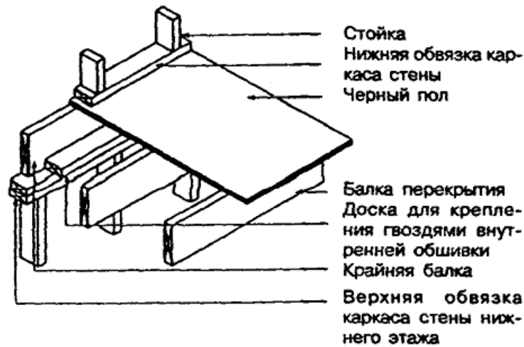
Рисунок 7.4 - Деталь установки доски для крепления внутренней обшивки
