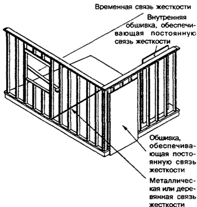
Рисунок 7.1 - Каркас стены
