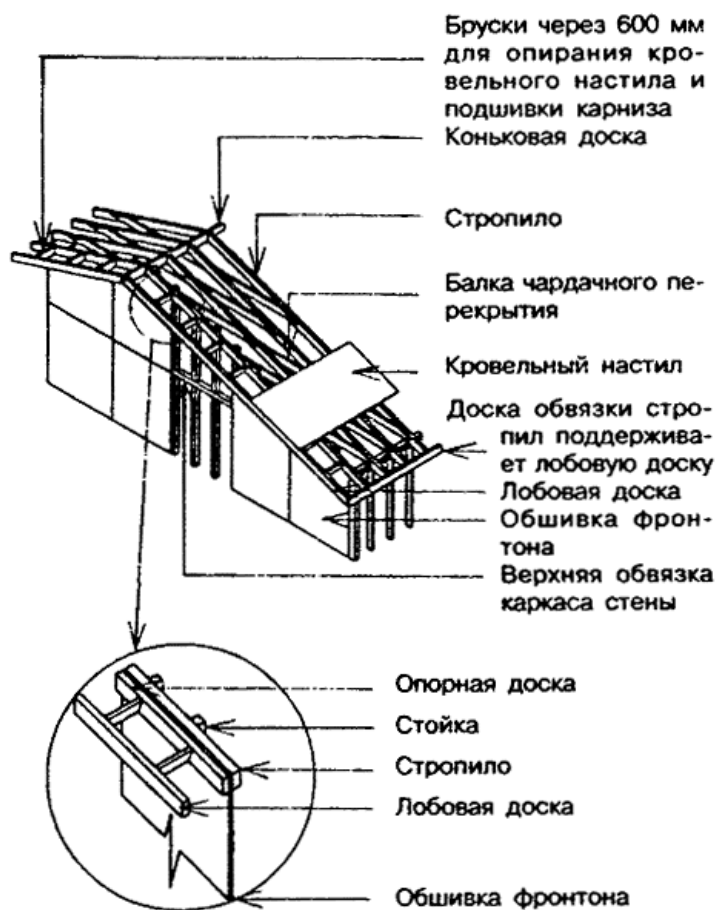
Рисунок 8.6 - Карниз над фронтоном с выносом 300 мм и менее
